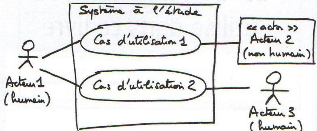
Figure A-1 Diagramme de cas d'utilisation (bases)
