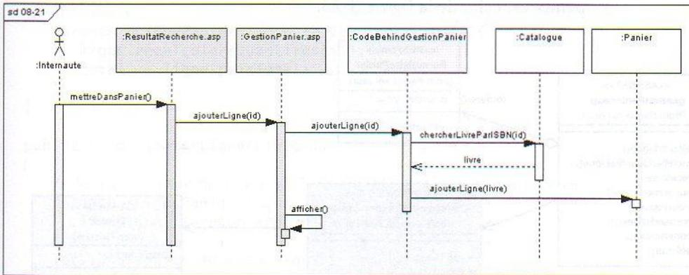
**Figure 8-21** Diagramme de séquence de la création d'une ligne du panier avec .NET
