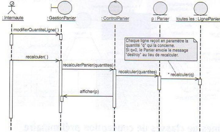
Figure C-26 Diagramme de séquence du scénario de recalcul du panier
