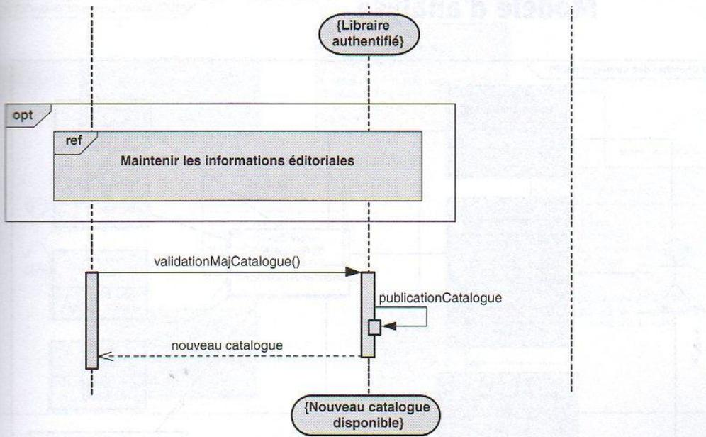
**Figure B-7** Diagramme de séquence système de Maintenir le catalogue (2<sup>e</sup> partie)
