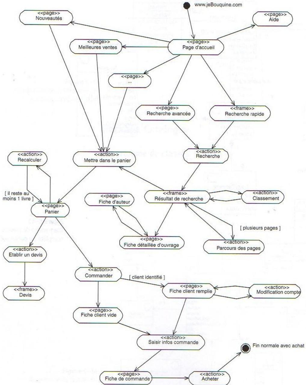
Figure C-16 Diagramme global de navigation de l'internaute
