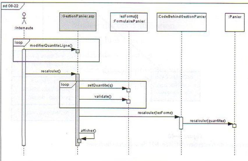
**Figure B-39** Diagramme de séquence de la gestion du panier avec .NET
