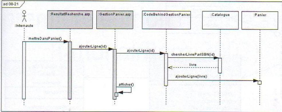
**Figure B-38** Diagramme de séquence de la création d'une ligne du panier avec .NET
