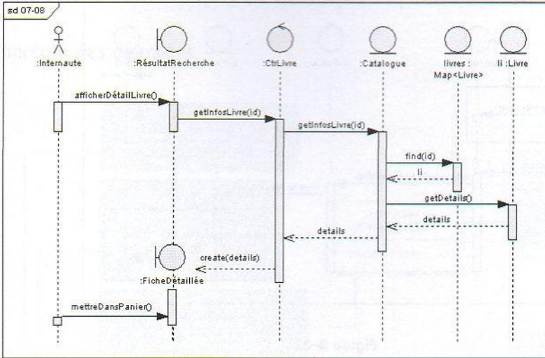
**Figure B-20** Diagramme de séquence de la suite du scénario nominal de recherche avancée
